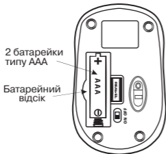
Мал. 4. Встановлення батарейок
