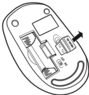
Рис. 7. Извлечение ресивера из корпуса мыши
