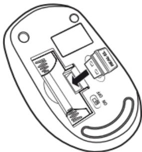
Рис. 6. Установка ресивера в корпус мыши
