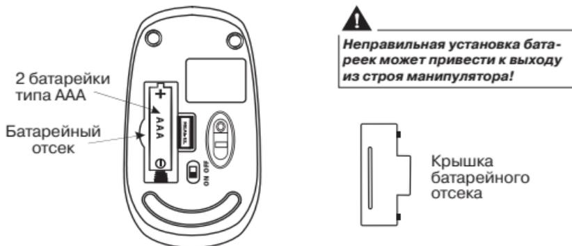
Рис. 4. Установка батареек
