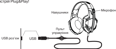
Мал. 2. Схема підключення
