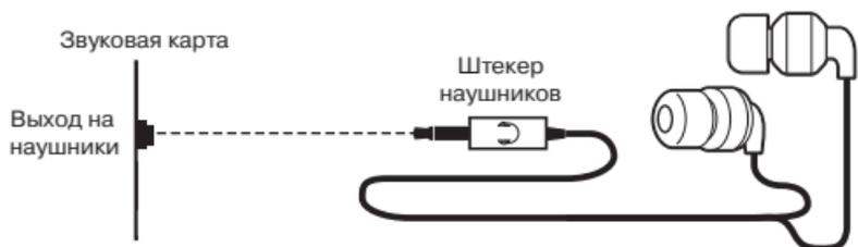
Рис. 1. Схема подключения
