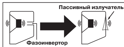
Рис. 2. Принцип действия пассивного излучателя
