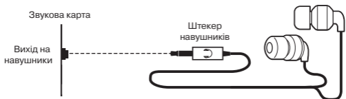
Мал. 1. Схема підключення
