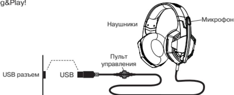
Рис. 2. Схема подключения
